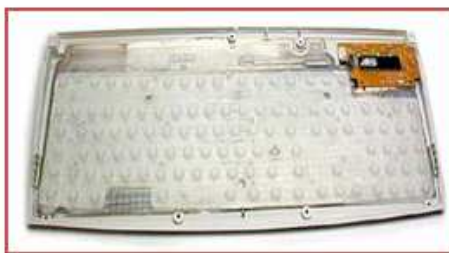
Figura 4 – Exemplo de slide da explicação do funcionamento das chaves de domo de borracha.
