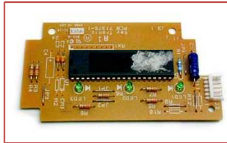
O microprocessador e o circuito controlador de um teclado
